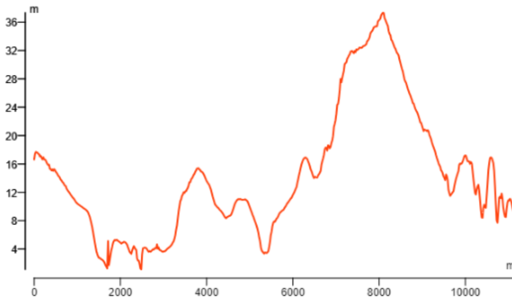
Figur 5: Terrænlængdeprofil fra Gråsten Syd til Nybøl
